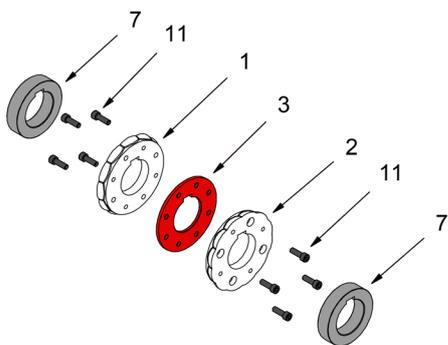
2. Nous faisons un pré-assemblage, sans serrer les vis, en accordant une attention particulière à l'alignement des rainures de la clé.
