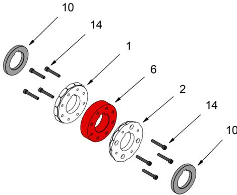
2. Nous faisons un pré-assemblage, sans serrer les vis, en accordant une attention particulière à l'alignement des rainures de la clé.
